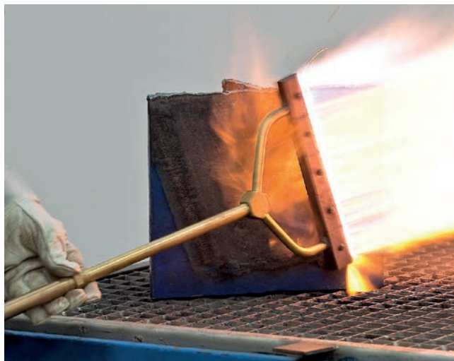
Obr. 4 – Čištění materiálu plamenem
