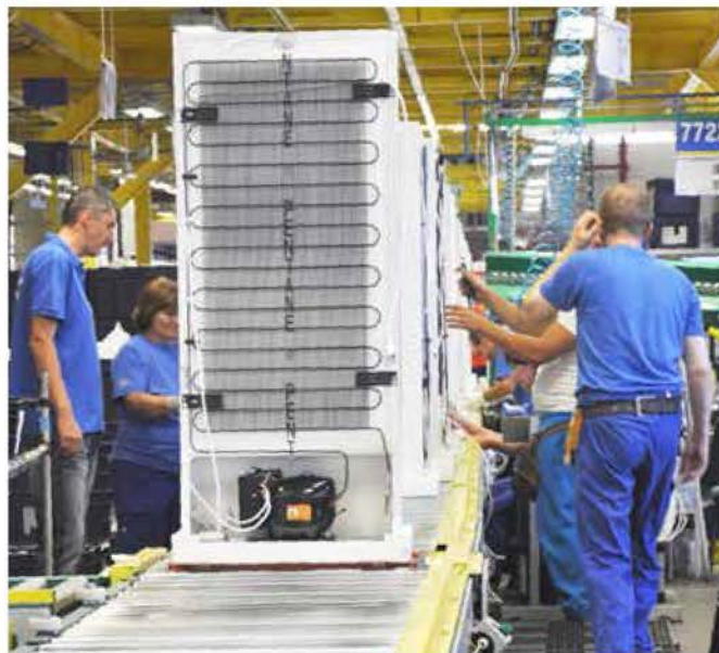
Pre výrobu chladničiek v spoločnosti Elextrolux Lehel sú plyny na spájkovanie a zvarovanie nepostrádateľné.
