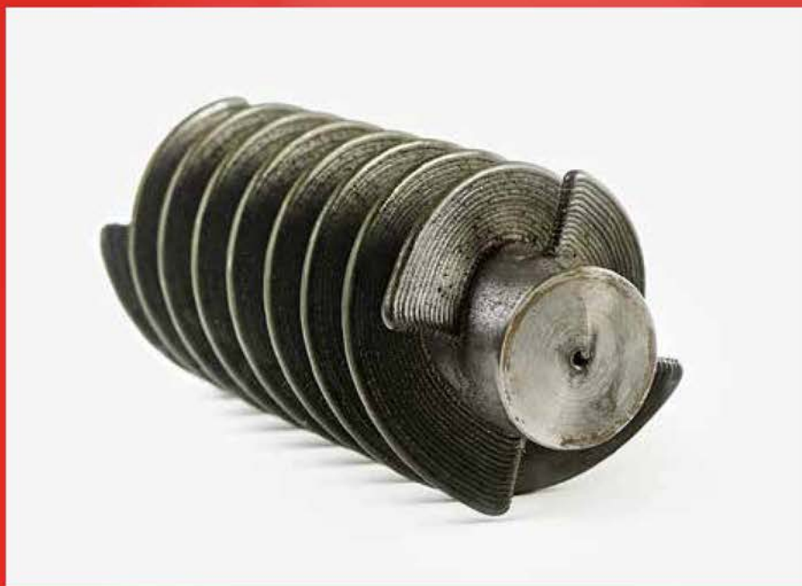
Pomocou 3D procesu sa dajú vyrobiť aj zložité kovové súčiastky.
