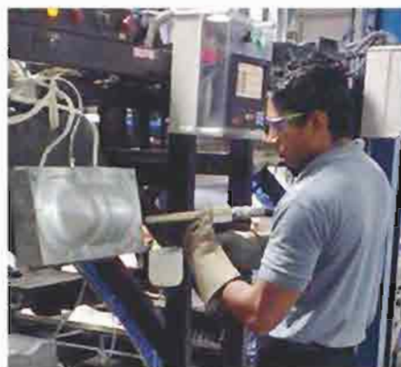
Tryskovanie suchým ľadom zabezpečuje jemné a účinné čistenie foriem použitých vo výrobe vyformovaných penových košíkov.
