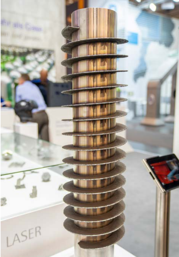
LMD-P gedruckte Förderschnecke
