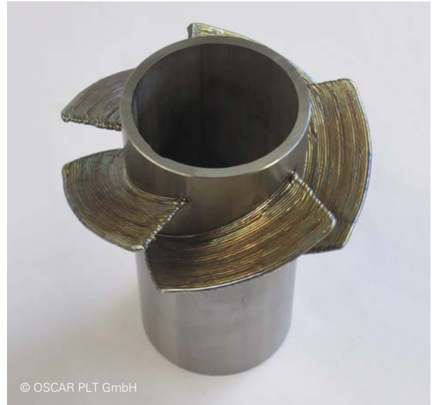
Koaxiales Laser-Metallauftragen mit Draht
