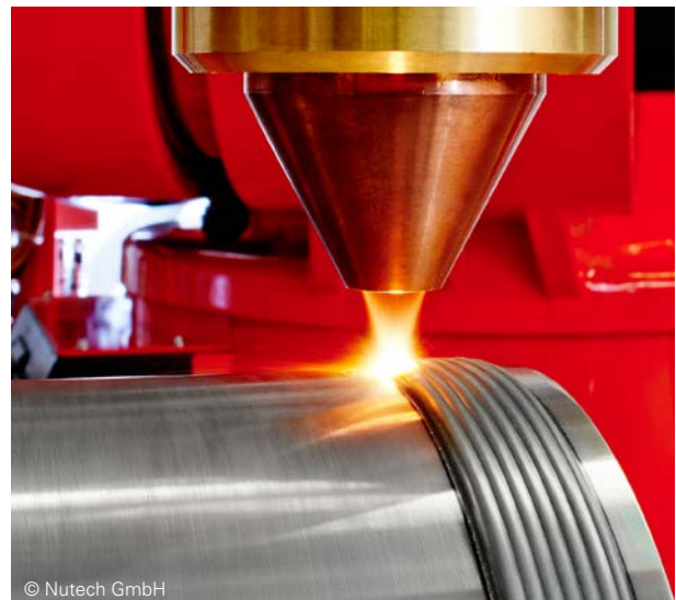
Laser Metallauftragen mit Pulver
