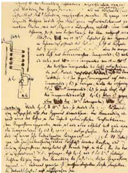
Gegenstromwärmetauscher mit Joule-Thomson-Ventil nach handschriftlichen Skizzen von Carl v. Linde
