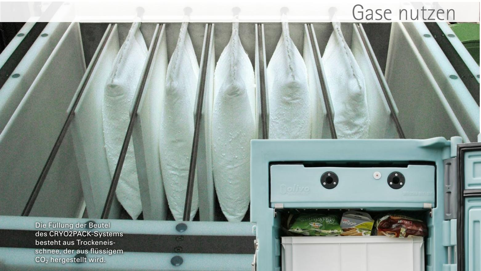
Die Füllung der Beutel des CRYO2PACK-Systems besteht aus Trockeneis-schnee, der aus flüssigem CO<sub>2</sub> hergestellt wird.
