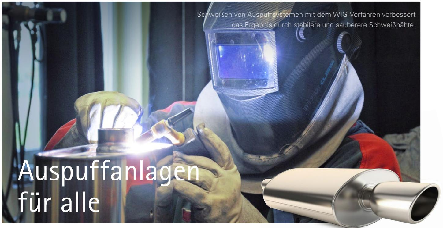
Schweißen von Auspuffsystemen mit dem WIG-Verfahren verbessert das Ergebnis durch stabilere und sauberere Schweißnähte.
