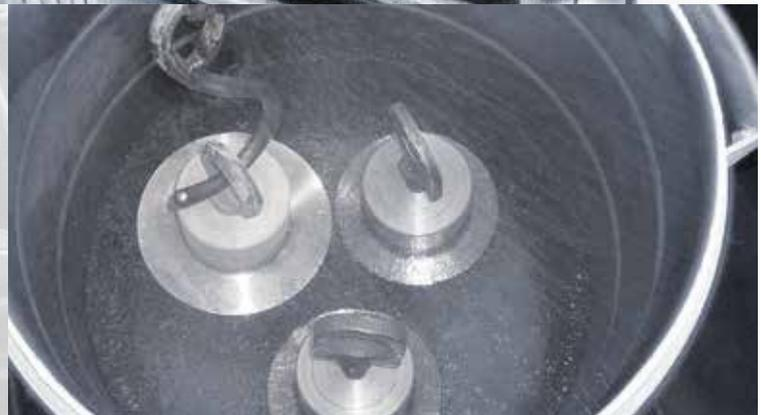
In einem Tauchbad werden innenliegende Bauteile stark abgekühlt, so dass sie minimal schrumpfen.
