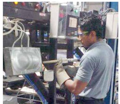
Dank der Trockeneisreinigung werden die Formwerkzeuge zur Herstellung von Büstenschalen geschont.
