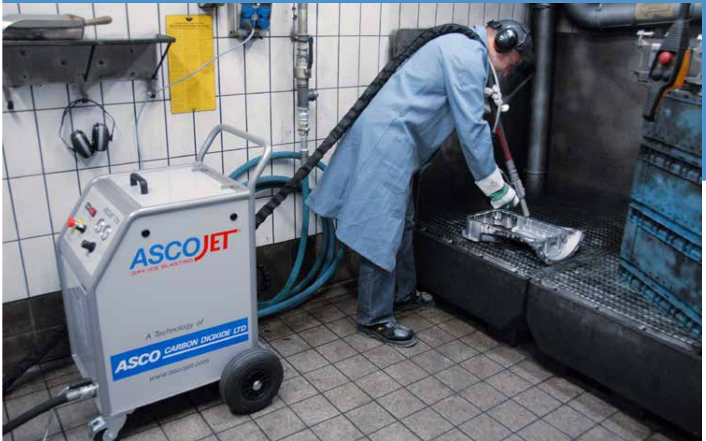
Reinigung eines Motorenbauteils mit der Trockeneis-Strahltechnologie von ASCO Kohlensäure
