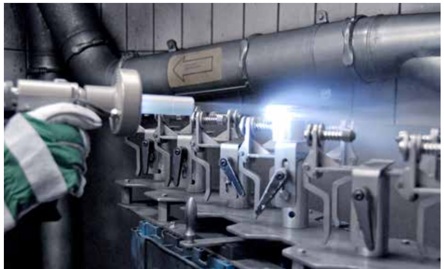
Der an der Pistole montierte Lichtkranz beleuchtet die schmale Ringnut bei der Reinigung.
