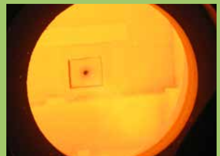
Der „flammlöse“ Oxipyr-Brenner von Messer – beim Aufheizen (oben) und bei 1.550 Grad Celsius (unten) – erreicht mit reinem Sauerstoff höchste Verbrennungseffizienz.
