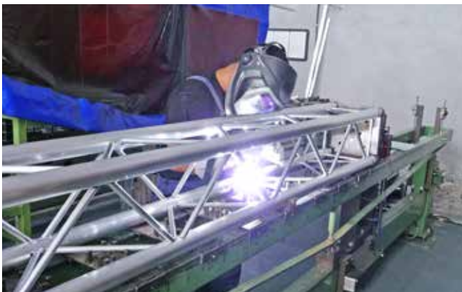
Schweißtechnische Fertigung mit dem WIG-Verfahren
